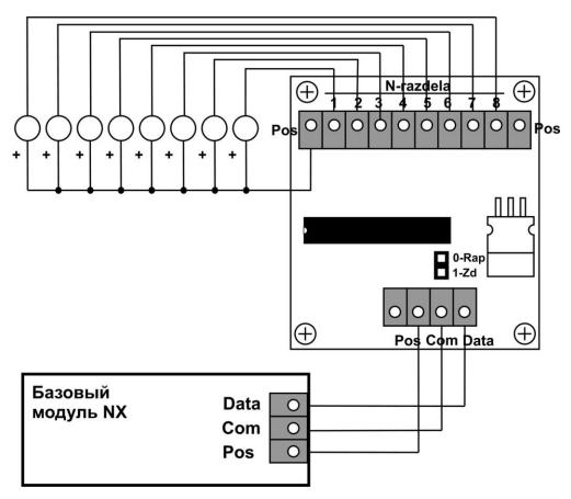
При подключении светодиодов, необходимо к каждому из них последовательно подключить резистор номиналом 1-3 кОм.
