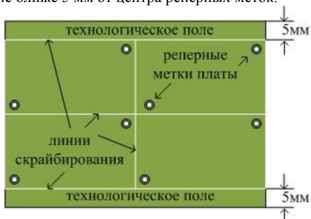
Рис. 9.1 Расположение реперных меток на печатной плате
